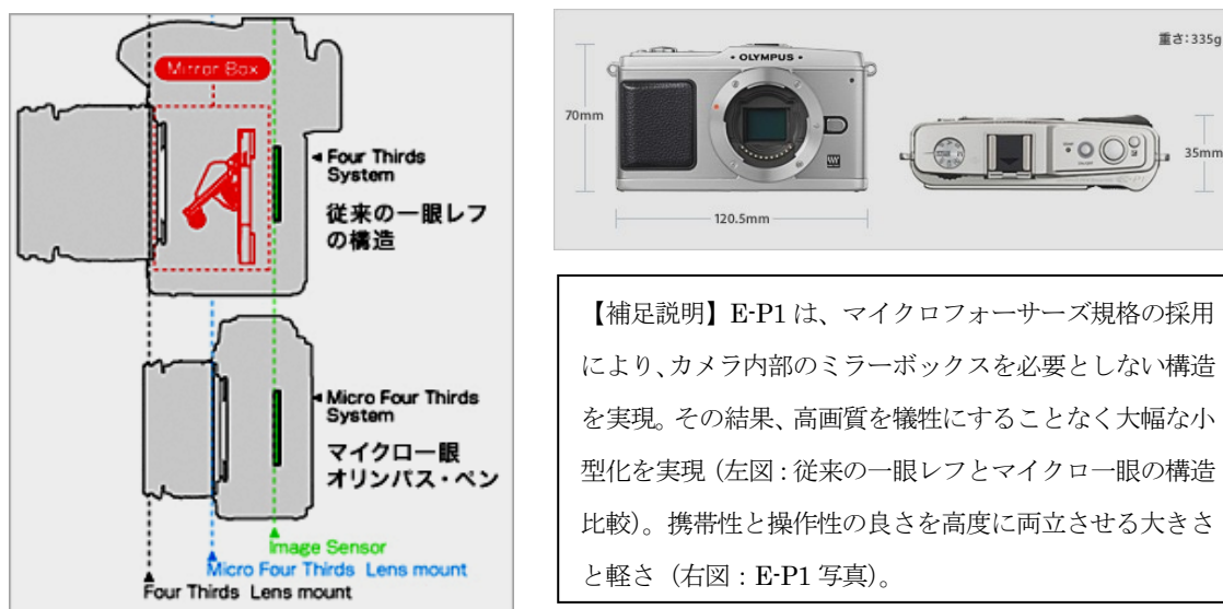
図表 10 E-P1 のマイクロフォーサーズ規格及びサイズ・重量
