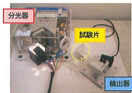
図 3.11 近赤外分光分析実験系 (408X-FTNIR: 京都パステック 製)
