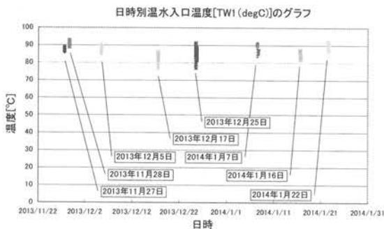
図 3.5.8 日時別温水温度の結果
