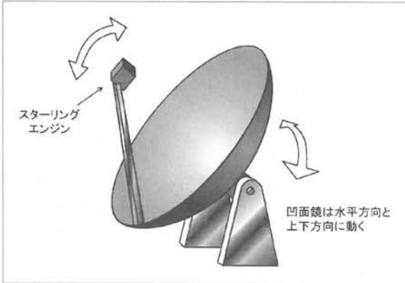
図 3.1.4 ディッシュ型太陽熱発電システム
