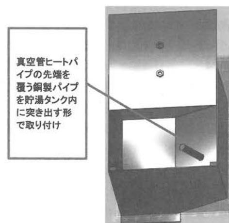
図3.3.7 貯湯タンク内の構造
