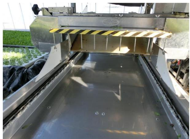
図 4.8 水耕栽培用バンドソー式刈取機
