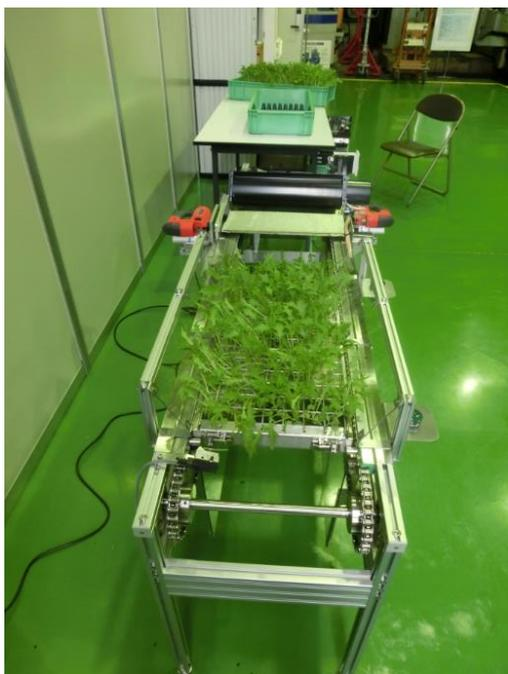
図 4.16 正立刈取時の収穫装置
