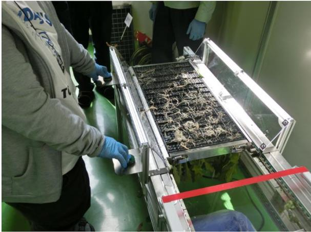
図 5-19 パレット生産対応型収穫装置の運転
