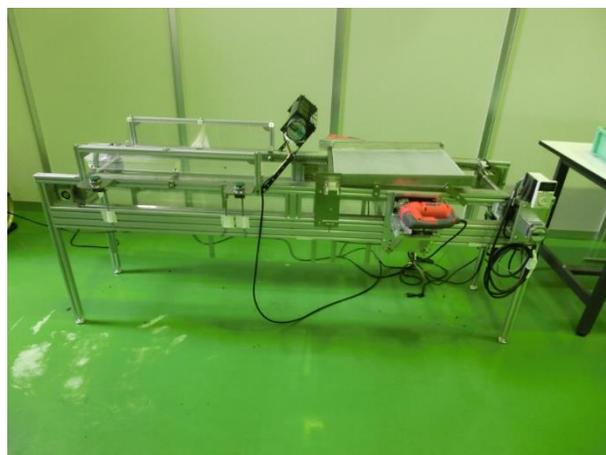
**図 4.15** 正立刈取方式の収穫装置
