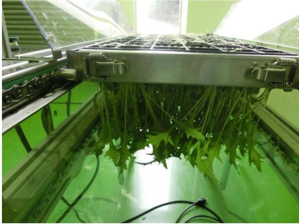
図 4.18 倒立刈取時の収穫装置
