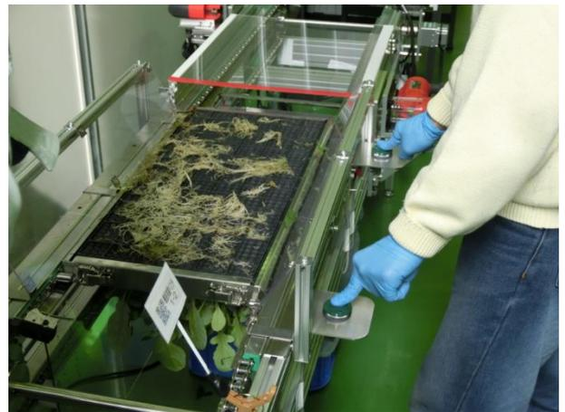
図 5-18 パレット生産対応型収穫装置の運転
