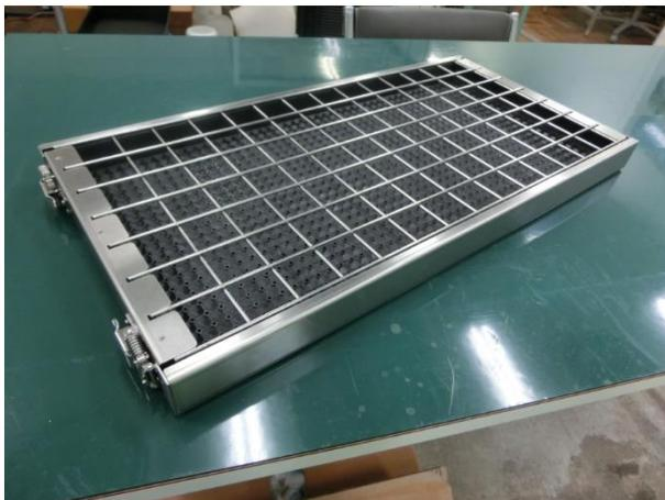
図 4.19 培地の落下を防止する金網と枠組みを取付けた育苗箱
