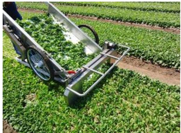
図 4.6 バンドソー式刈取機による収穫作業
