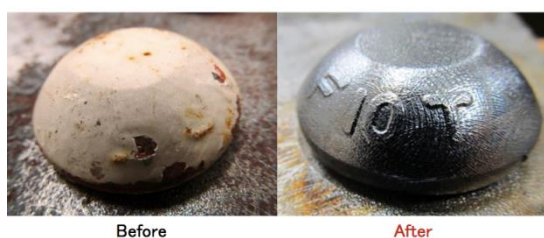
図表① クーレーザーによる塗膜除去の効果
