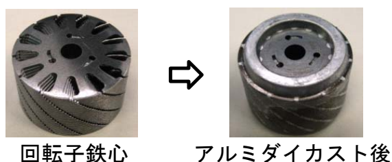
図4 アルミダイカストによる二次導体の形成
