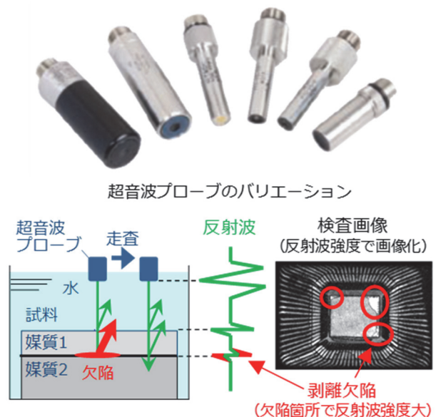
図3 超音波プローブと検査原理の概要
