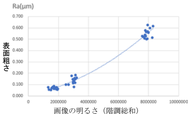
図10 表面粗さと画像の明るさ(階調総和)
