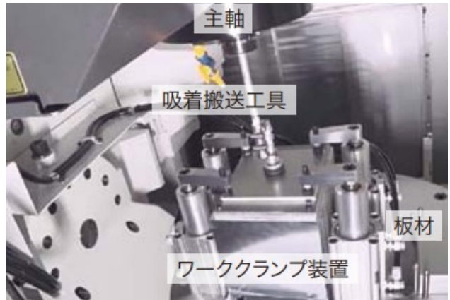
図7 開発した新積層造形装置・機能
