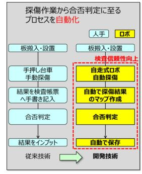
図6 本ロボットによる探傷プロセス自動化
