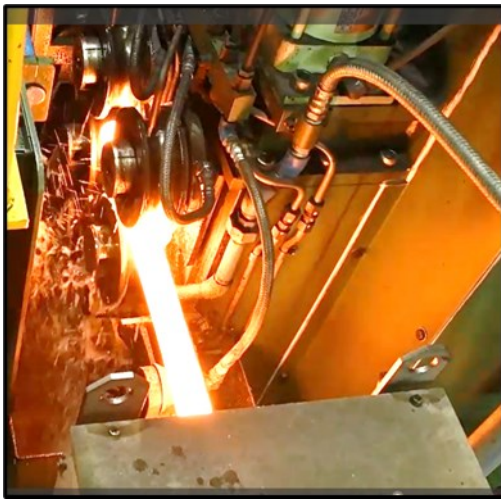
図6 バー材供給部
