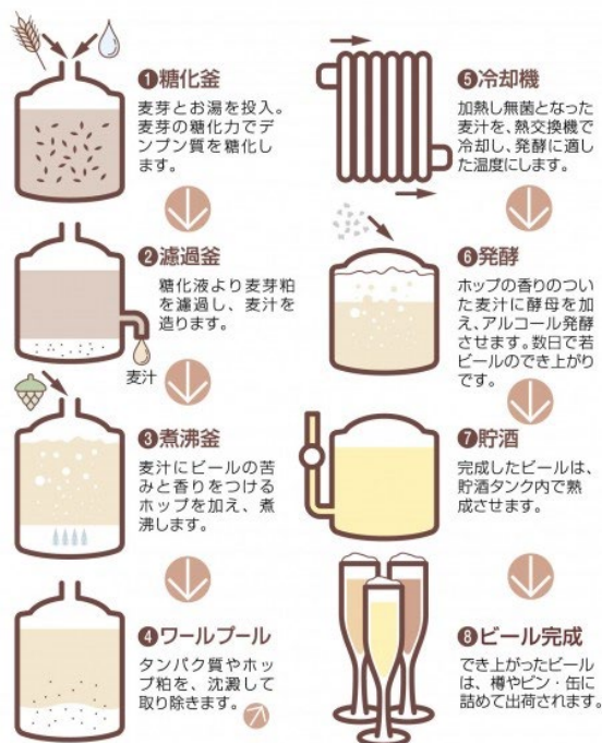
図表2 ビールの製造プロセス
