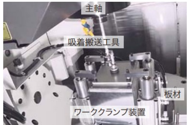
図7 開発した新積層造形装置・機能
