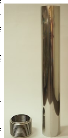
図9 素管と1/10圧縮したベローズ管
