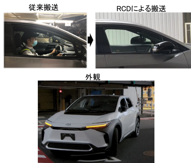
図2 RCDによる車両搬送の様子
