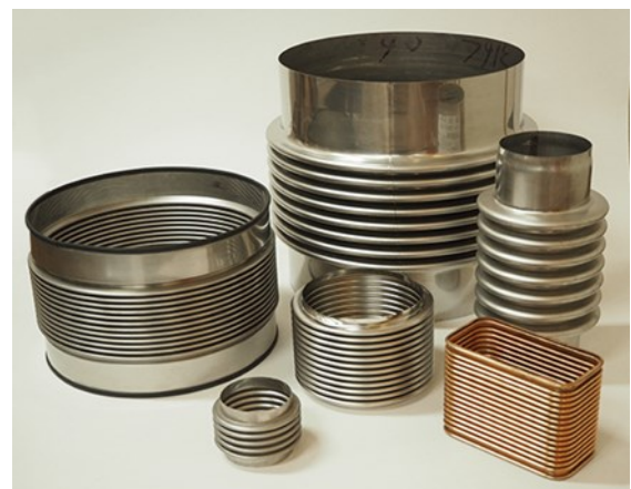
図10 本装置による素管で形成されたベローズ管
