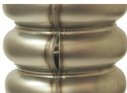
図1 破断したベローズ管
