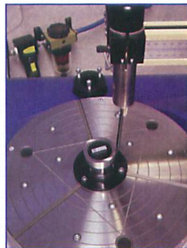
図2 b) 切欠き標準の測定状況
