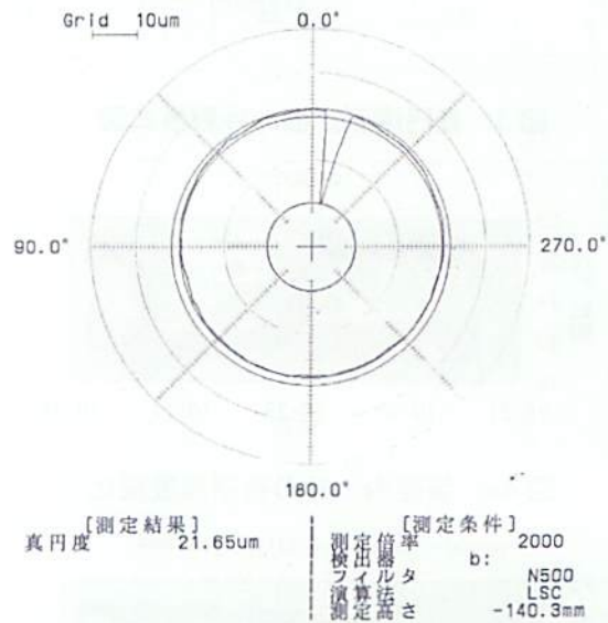
図7 直径5mmの切欠き標準
