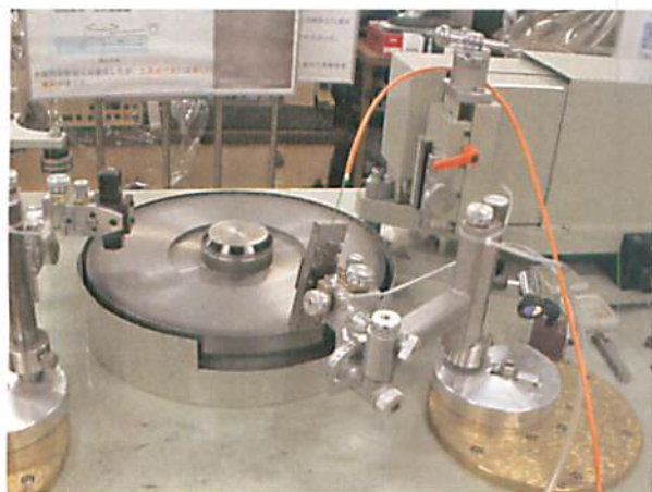
図 4.24 スカイフ盤と光ファイバの摩擦温度測定
