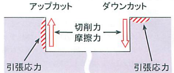
図 4.34 チッピング発生メカニズム
