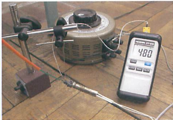
図4.9 放射温度計の校正方法
