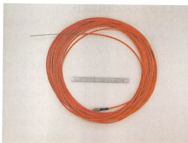
図 3.6 切削温度計測に用いた光ファイバ
