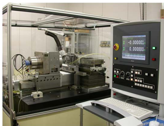
図 1-1 開発した超精密旋盤
