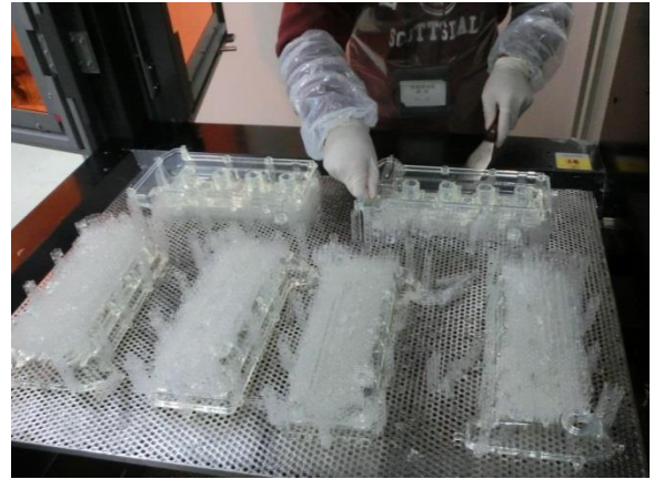
図 3.20 造形物の取り外しの様子
