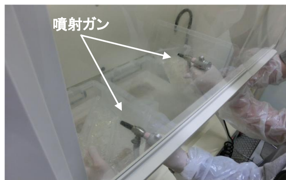
図3.2.17 噴射ガンによる二次洗浄作業
