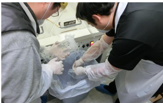
図3.2.15 サポート材の除去作業
