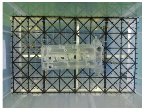
図3.2.12 洗浄槽内の3D造形品
