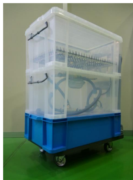
図3.2.11 洗浄装置外観(2)
