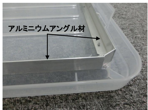
図3.2.3 対策後のフタ(部分)
