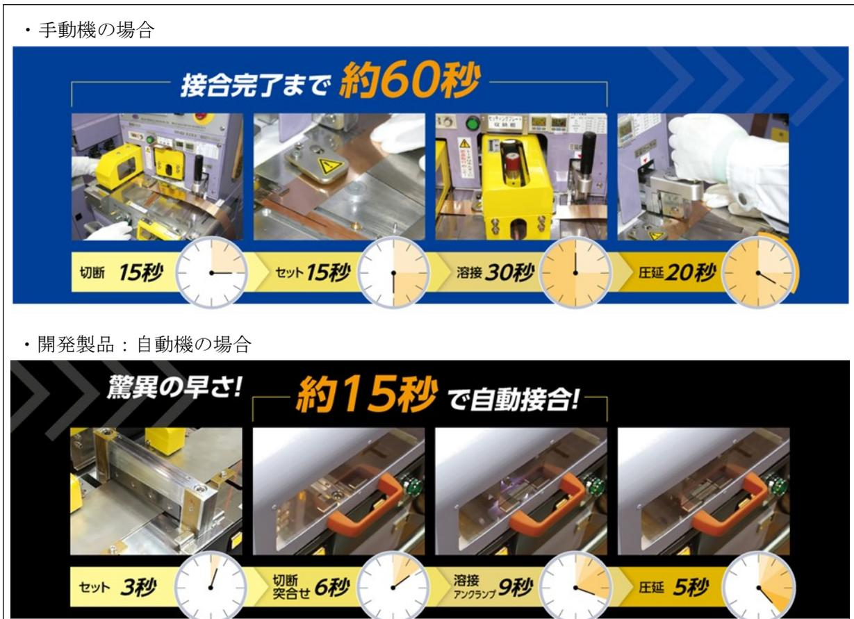
図2 手動機と自動機の作業および作業時間の比較
