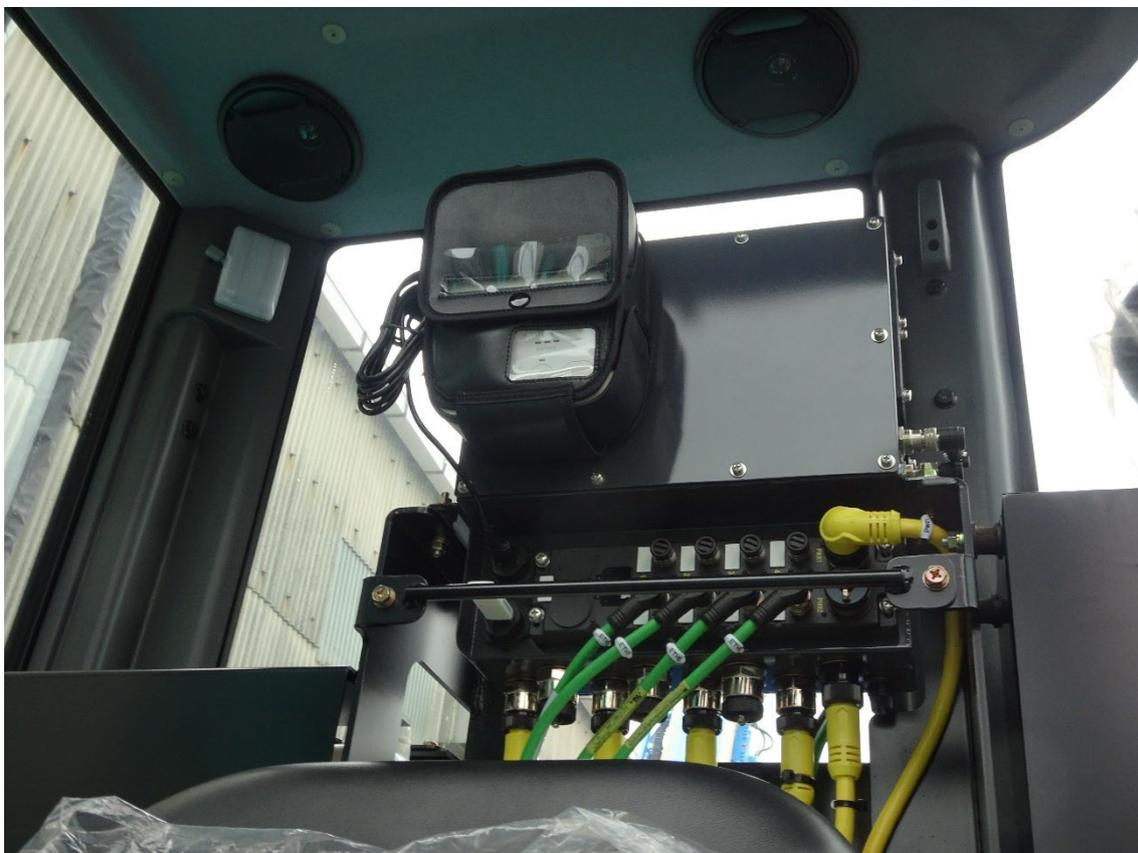
図4 コントローラ（上）とそれに直接つながるスイッチングハブ（下）
