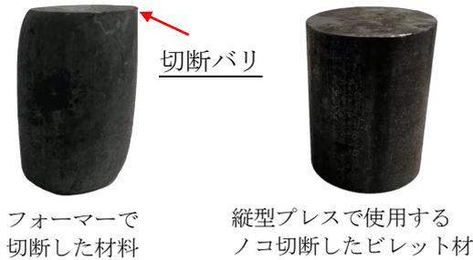
図2 切断した材料
