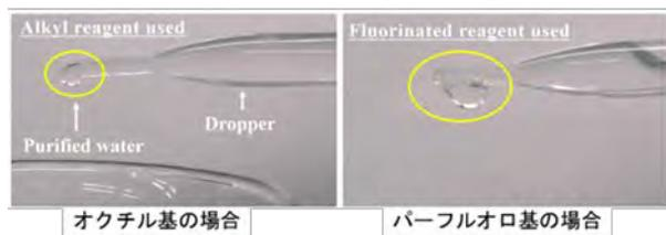
図9 動的撥水性特性による液垂れの相異
