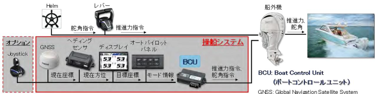
図2 開発した操船システムを備えたボートの一般的な構成
