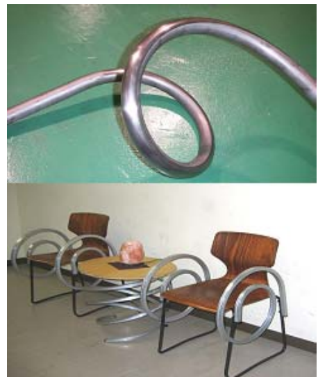
図 2 三次元曲げ加工の一例
